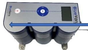
Abb. 35: Einschieben der Verriegelung Zentrale – Kartusche
