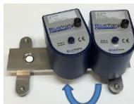
Abb. 32: Die zweite Kartusche muss links von der ersten Kartusche in einem Winkel von 10° platziert werden.
