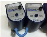
Abb. 33: Die dritte Kartusche muss ebenfalls in einem Winkel von 10° von links nach rechts platziert werden. Beginnen Sie beim Ausbau der Kartuschen von links nach rechts
