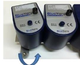
Abb. 68: Erster Schritt beim Entfernen der Kartuschen
