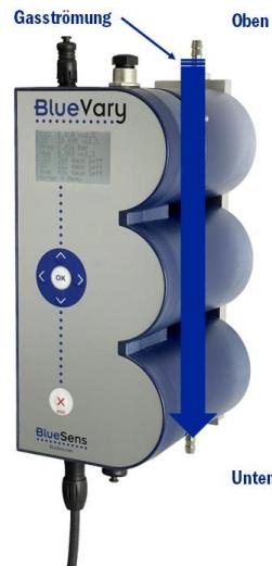
Abb. 37: Gasströmung im **BlueVary**, „von oben nach unten“, damit Flüssigkeiten ausgespült werden können.
