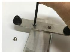
Abb. 28: Befestigung der Montageplatten am Durchflussadapter
