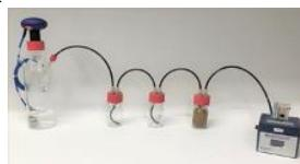
Abb. 33: Beispielinstallation für einen BMP-Testplatz mit CO<sub>2</sub> Absorber und H<sub>2</sub>S Absorber
