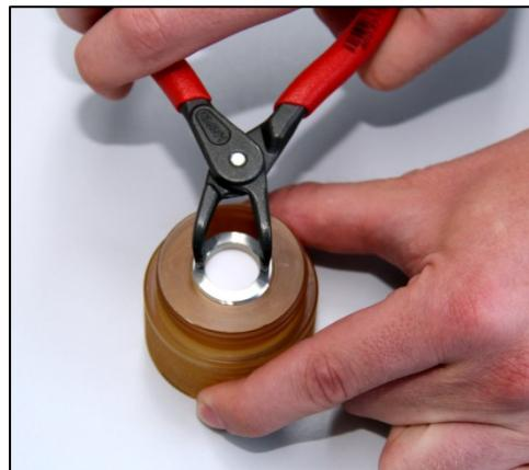
Abb. 45: Filterwechsel PES-Kappe
