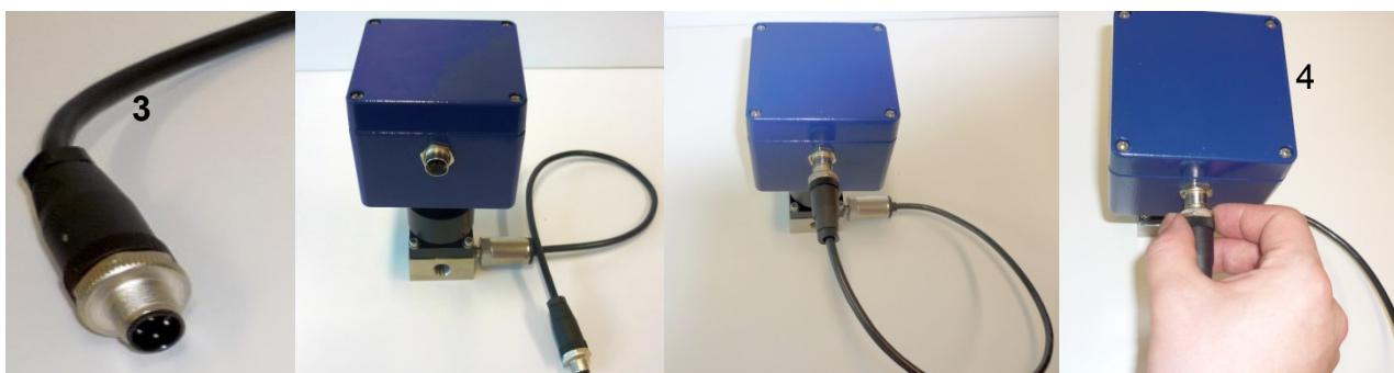
Abb.47: Verbindung Drucksensor und Gassensor (optionales Zubehör)
