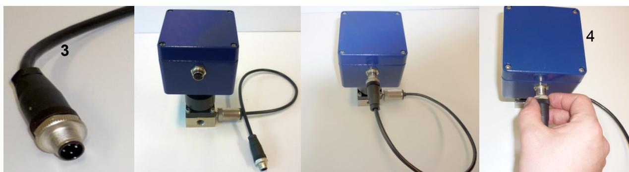
Abb.37: Verbindung von Drucksensor und Gassensor
